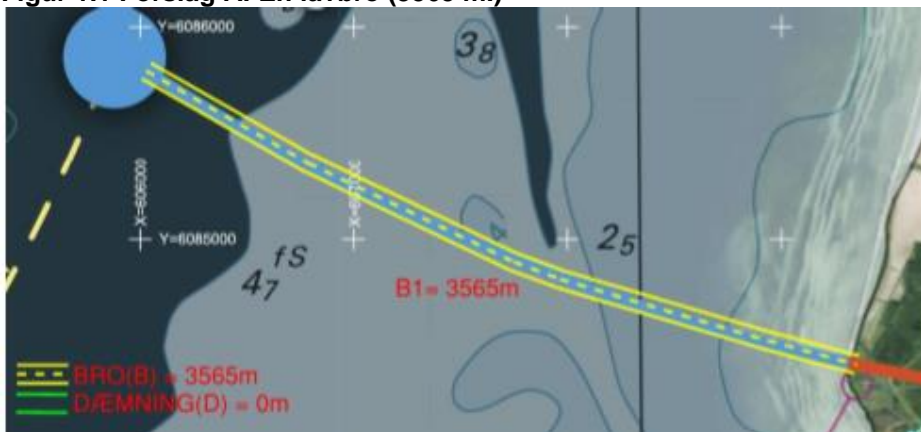
Figur 1.2. Forslag B: to lavbroer (800 m. + 425 m.) og en dæmning (2340 m.)
